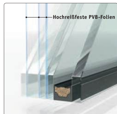
Durchbruchhemmende Verglasung der Klasse P6B nach DIN EN 356
