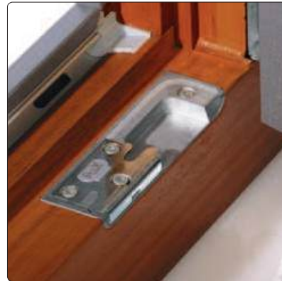
Bündig ins Holz eingelassene Beschläge erhöhen die Einbruchhemmung und sind besser zu reinigen. | Seite 17
